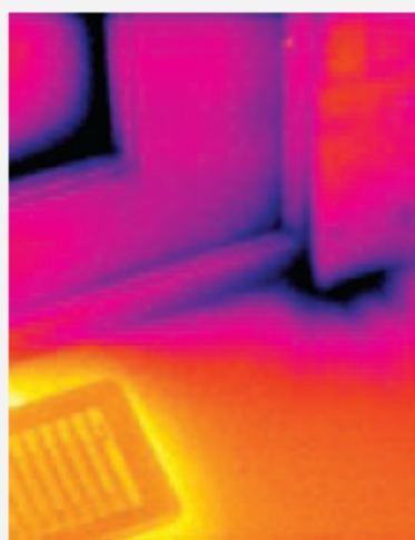
Figura 6-6. Le mappe di temperatura relative alle perdite di aria spesso hanno una caratteristica mappatura termica "a ciuffi".
